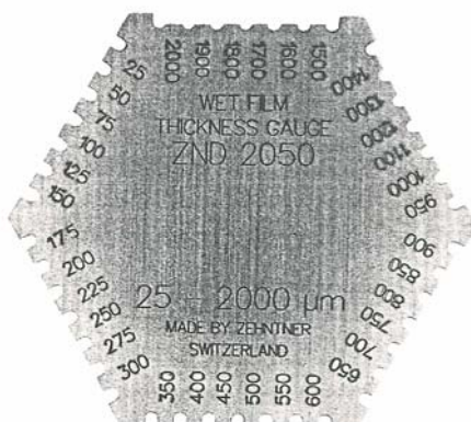
Slika 3. Češalj za mjerenje debljine mokrog sloja premaza
