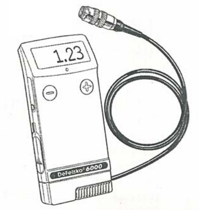
Slika 4. Uređaj za mjerenje debljine suhog filma DeFelsko 6000 FSN2.
