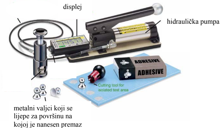
Slika 5. PosiTest uređaj za ispitivanje prionjivosti
